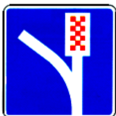
6.5 Полоса для аварийной остановки
