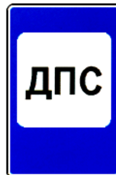
7.12 Пост дорожно- патрульной службы
